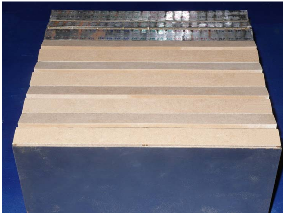
Bild 1.2 Windkanalmodell des Aufstellsystems „ilzoeasy“ mit einer vollständigen Dachbelegung
